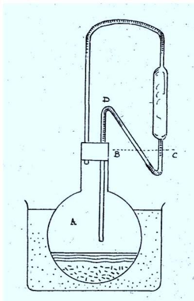
Fig. 9. — *Appareil digesteur à chaud.* — La matière située dans le ballon A est soumise au bain de sable ; sur le ballon est luté un tube courbé débouchant dans une allonge où se refroidissent les gaz et vapeurs. Lorsque le liquide condensé dans la courbe en BC atteint le sommet de cette courbe D, il se siphonne automatiquement et tombe dans le ballon pour être évaporé à nouveau.
