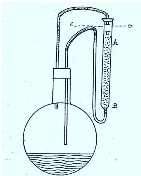
Fig. 8. — *Appareil digesteur et lixivateur à froid.* — Même principe, mais la matière occupe le tube refroidisseur A B. Le liquide évaporé se condense sur cette matière jusqu'à ce qu'il occupe le niveau C D, où se siphonne dans le, ballon.
